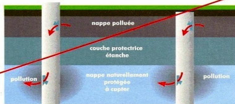
Forage en service perforé
