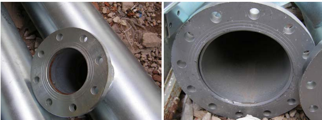
FIG. 19: CRITICITA' ANCHE NELL'ACCIAIO INOX AISI 316L
