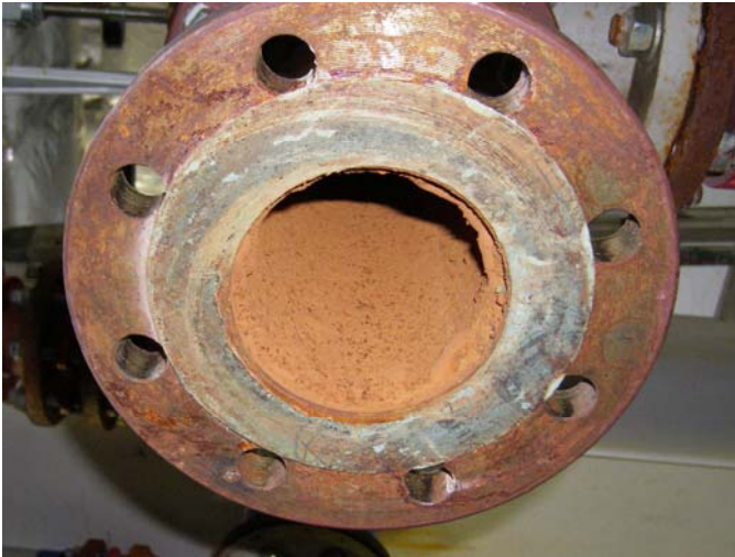
FIG. 18: CONCREZIONI SOSPETTE PER IL BIOFILM
