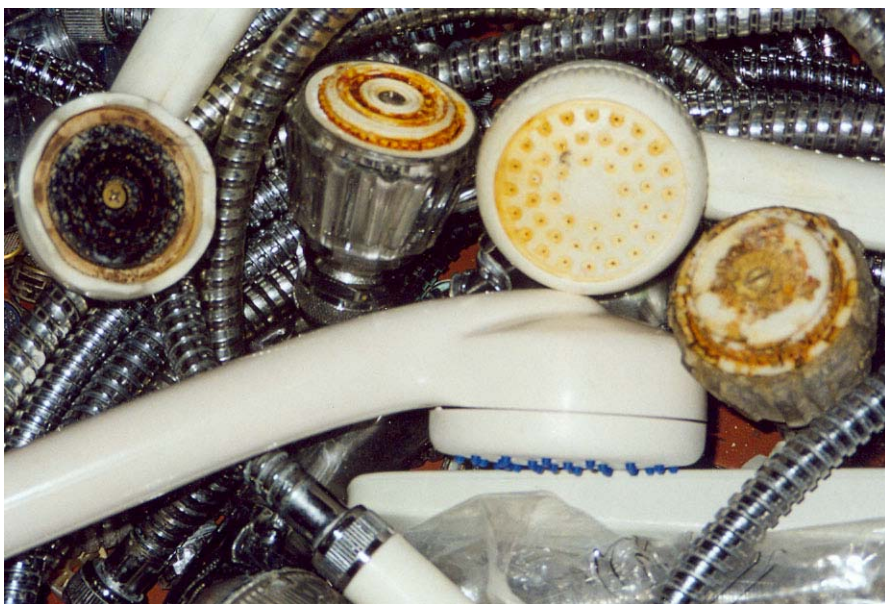
FIG. 16: INCROSTAZIONI E CORROSIONI
