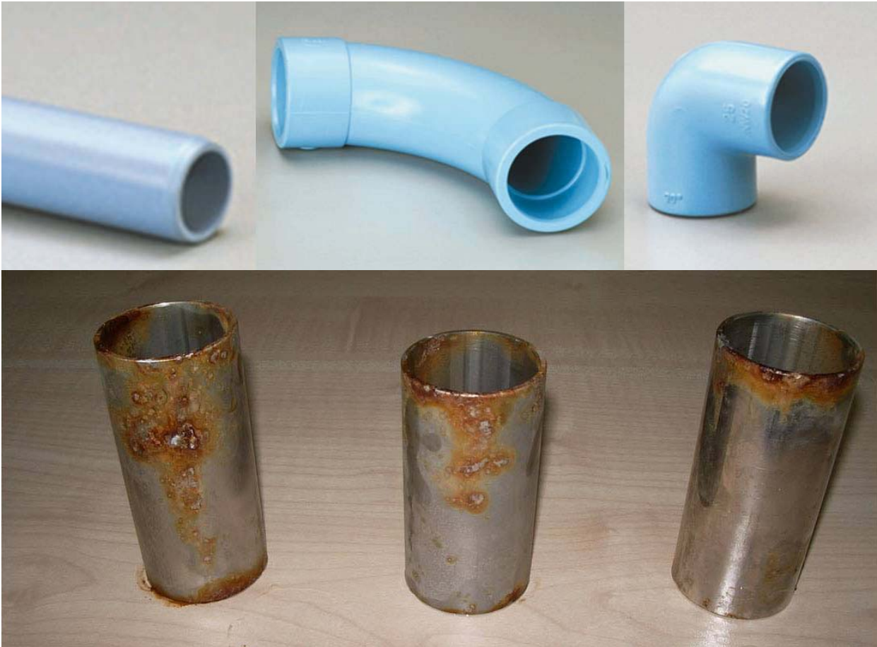
FIG. 17: CONFRONTO TRA MATERIALI DIVERSI PER IL TRASPORTO ACQUA
