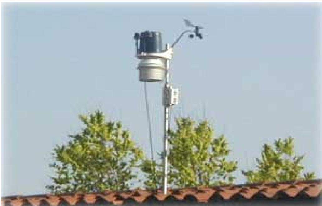
Essa costituisce un importante elemento di riferimento nella rilevazione di dati biometeorologici nel contesto di un'isola climatica di calore come la città di Milano. Attraverso la stazione meteo saranno rilevati anche i campi della temperatura, umidità, vento, radiazione solare, UV.
